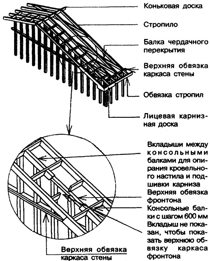
**Рисунок 8-7** — Карниз над фронтоном с выносом более 300 мм
