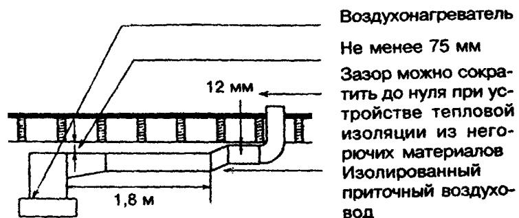
Рисунок 13-1 — Воздуховоды воздушного отопления
