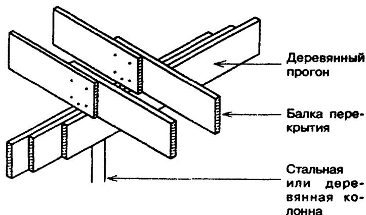
*Рисунок 6-7 — Опирание балок перекрытия на деревянный прогон*
