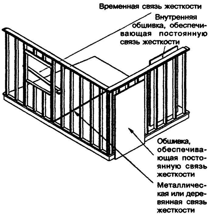
*Рисунок 7-1 — Каркас стены*
