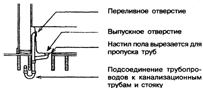
*Рисунок 13-6 — Детали установки умывальника и ванны*
