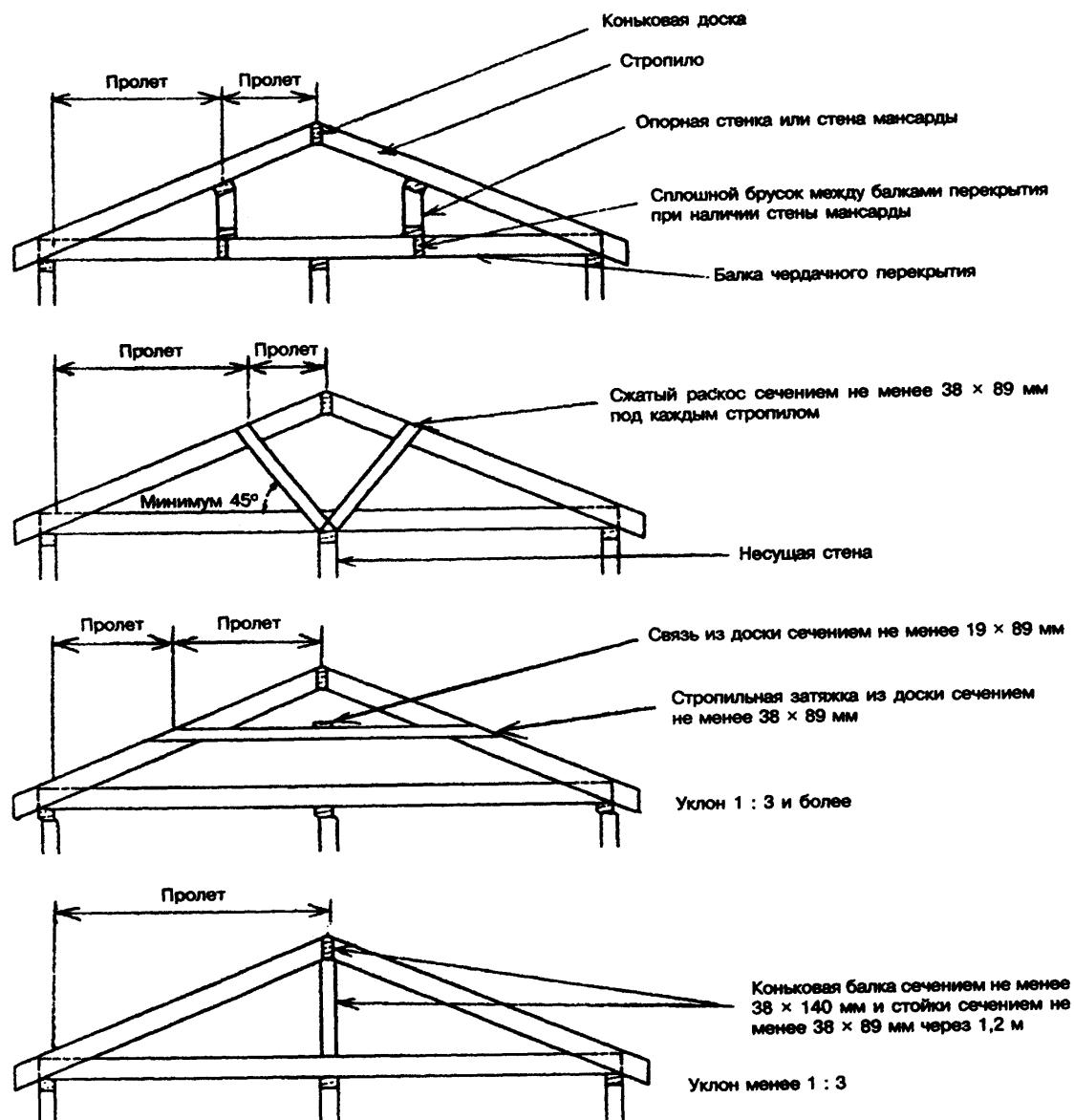
Рисунок 8-1 — Элементы несущего каркаса скатной крыши
