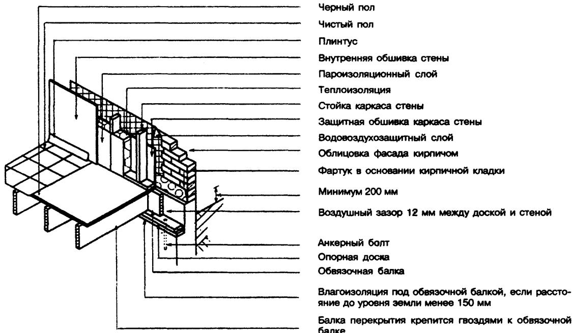
*Рисунок 6-5 — Опирание балок перекрытия на опорную доску, уложенную на уступ фундаментной стены*
