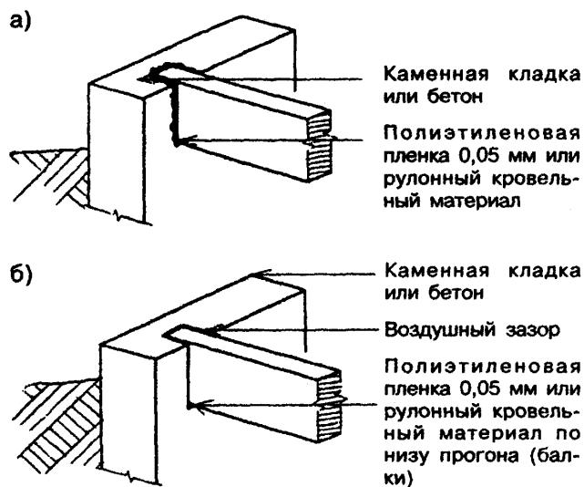
*a* — низ прогона (балки) расположен над уровнем грунта;
