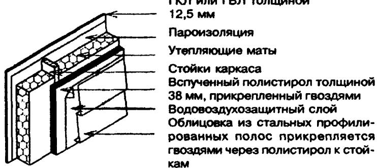
а — утеплитель между стойками каркаса стены; б — утеплитель между стойками каркаса стены с дополнительным слоем жесткого утеплителя снаружи
