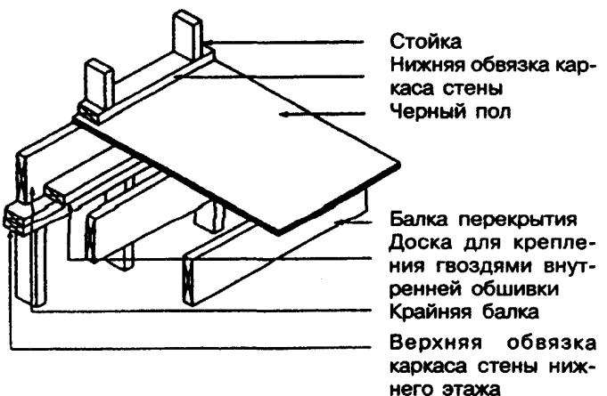
**Рисунок 7-4** — Деталь установки доски для крепления внутренней обшивки
