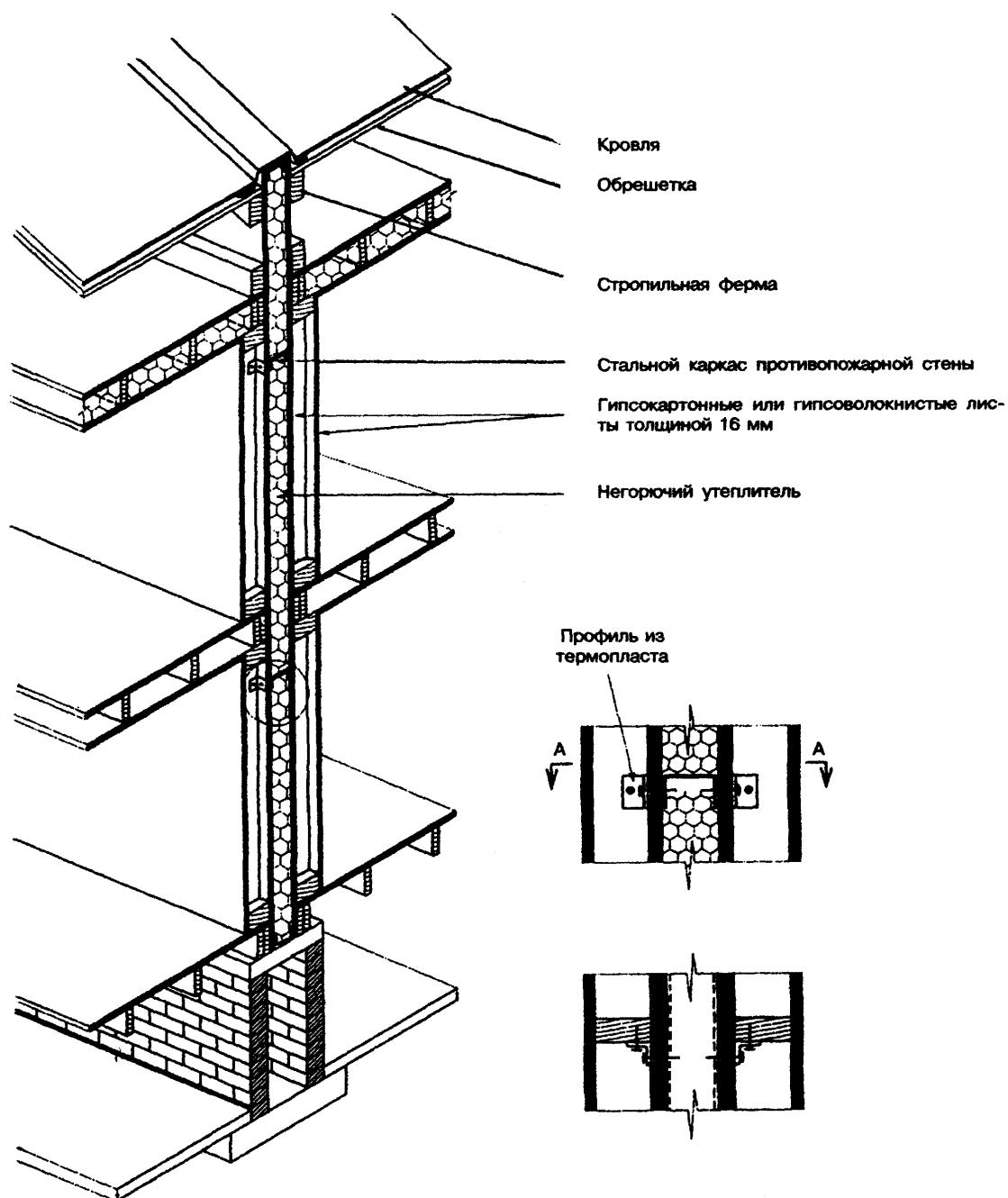
*Рисунок 7-6 — Межквартирная противопожарная стена
