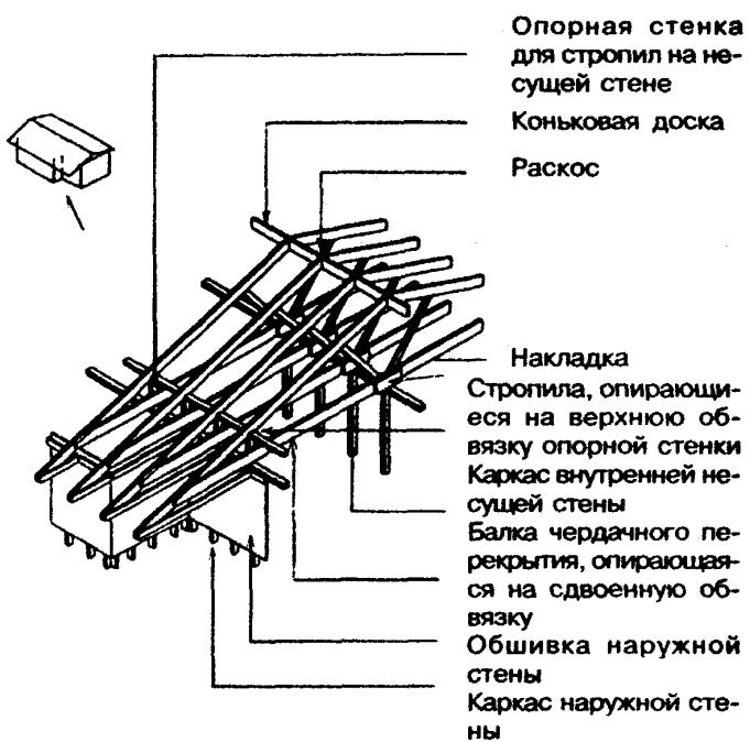
*Рисунок 8-3 — Устройство каркаса скатной крыши при смещении внутрь дома наружной стены*
